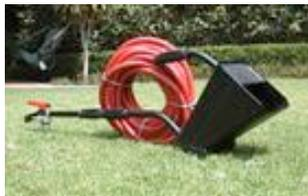
Para la utilización de este sistema es necesario un compresor de aire, una manguera de aire y un lanza mortero. El mortero se tiene que preparar en una ligadora de concreto y transportar al lugar del revoque por el método deseado.
